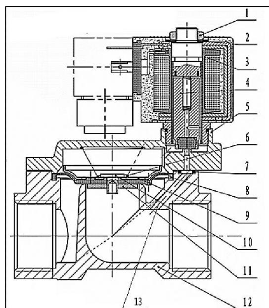
**КЛАПАН ДВУХПОЗИЦИОННЫЙ ЭЛЕКТРОМАГНИТНЫЙ НЕПРЯМОГО ДЕЙСТВИЯ НОРМАЛЬНО ОТКРЫТЫЙ рис.2**
